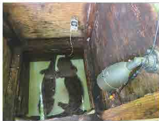
図2-5. 繁殖水槽に設置している赤外線ビデオカメラと水温データロガー
